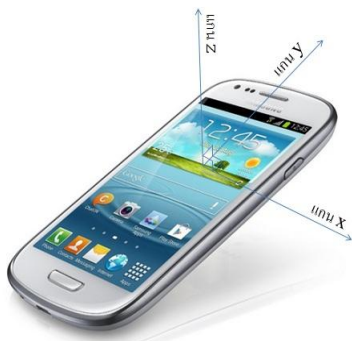
รูปที่ 2 แกนการเคลื่อนที่ 3 แกนของสมาร์ทโฟนที่วัดได้จาก
